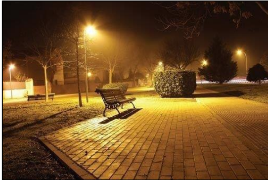
Figura 3: Aplicação de lâmpadas de vapor de sódio em IP em IP
