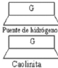
Nota: Estructura del mineral caolinita. Fuente: Fundamentos de mecánica de suelos, por Roy Whitlow, 1999.
